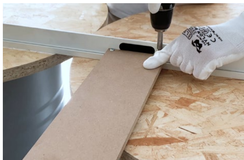
Montare i distanziali in corrispondenza delle cerniere. Assembly spacers in correspondence of door hinges.
