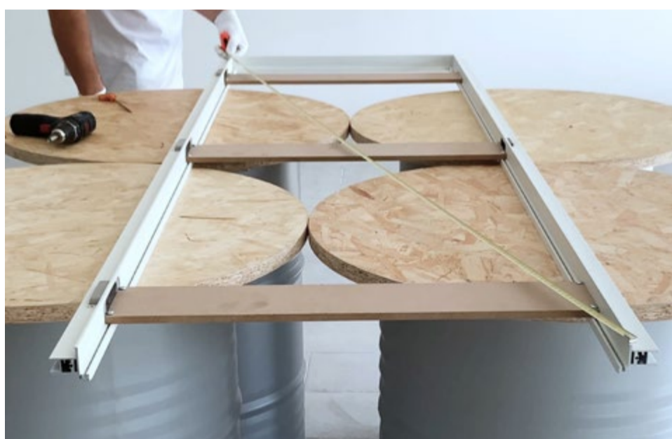
Verificare che le diagonali siano della stessa misura. Verify diagonals are the same size.
