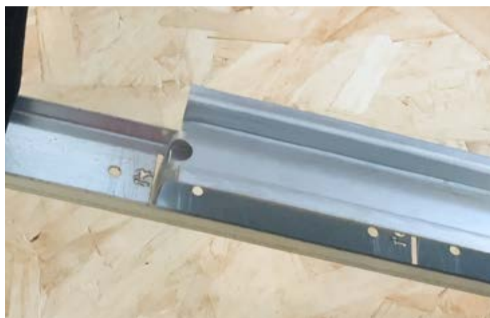
Inserire i distanziali nelle asole indicanti le dimensioni dell'anta doppia da realizzare. Insert spacers in the holes according to the double door size to obtain.
