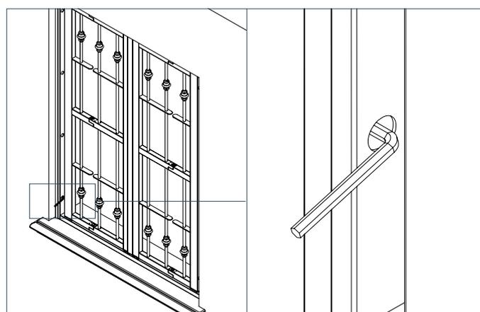
**4** Riposizionare i profili di recupero fuorisquadro sul telaio ed inserire il tutto nel vano muro fino a far coincidere le forature di fissaggio. Mediante una chiave esagonale da 6mm spingere le viti di recupero fuorisquadro dividendo le luci e posizionando il telaio centrato nel vano.
