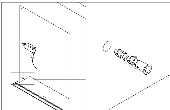
**3** Estrarre il telaio dal foro muro e praticare la foratura con punta diametro 8mm per l'inserimento dei tasselli ad espansione forniti in dotazione.
