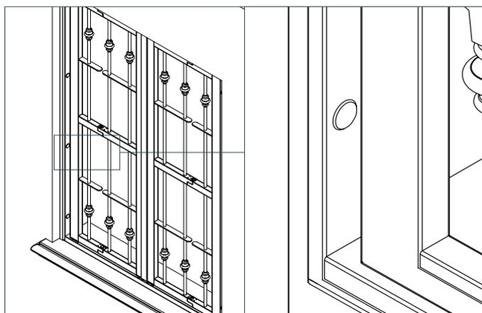
**11** Controllare a questo punto l'apertura degli snodi, la chiusura del catenaccio e della serratura. Rifinire il tutto mediante tappini copriforo (L) forniti in dotazione.
