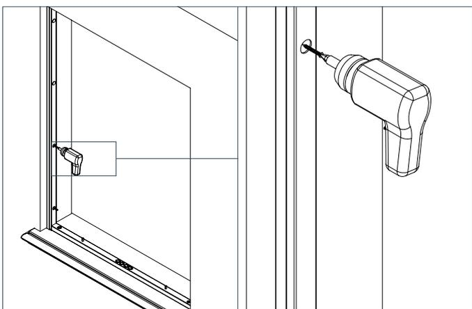
**9** Controllare un'ultima volta che tutte le viti di recupero fuorisquadro spiano spinte contro il profilo e la parete. Procedere ora al fissaggio del telaio mediante viti fornite in dotazione.
