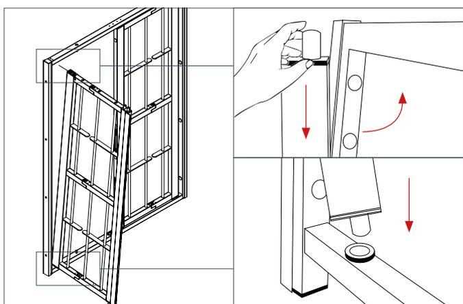
**10** Inserire l'anta nella boccola inferiore. Spingere il perno superiore della cerniera fino a farlo entrare sul telaio e assicurarsi che il perno si infili completamente nella boccola superiore.
