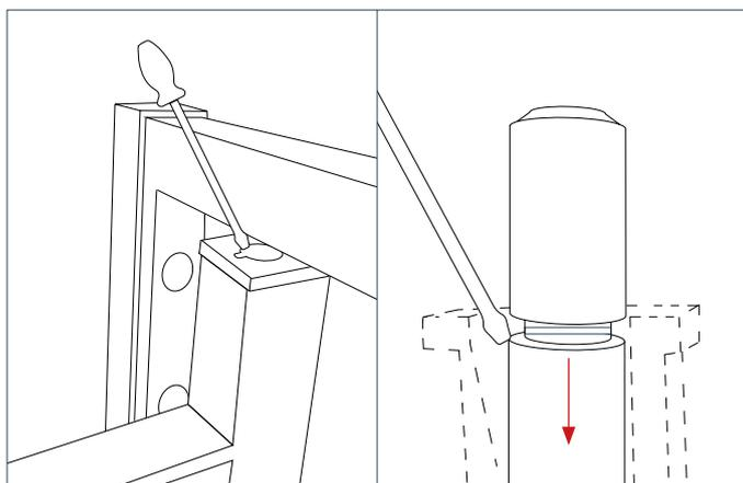
**7** Aprire l'anta a 90° e infilare un cacciavite a punta fine nel foro superiore della cerniera. Estrarre la parte superiore dell'anta.
