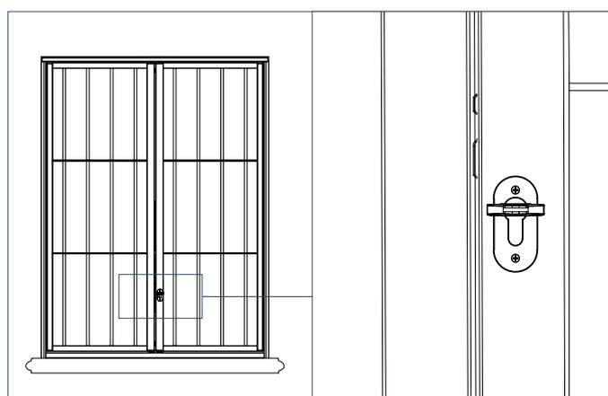
**6** Provare la corretta chiusura della chiave e del catenaccio posto sull'anta secondaria, se necessario continuare la regolazione fino ad ottenere il risultato voluto.
